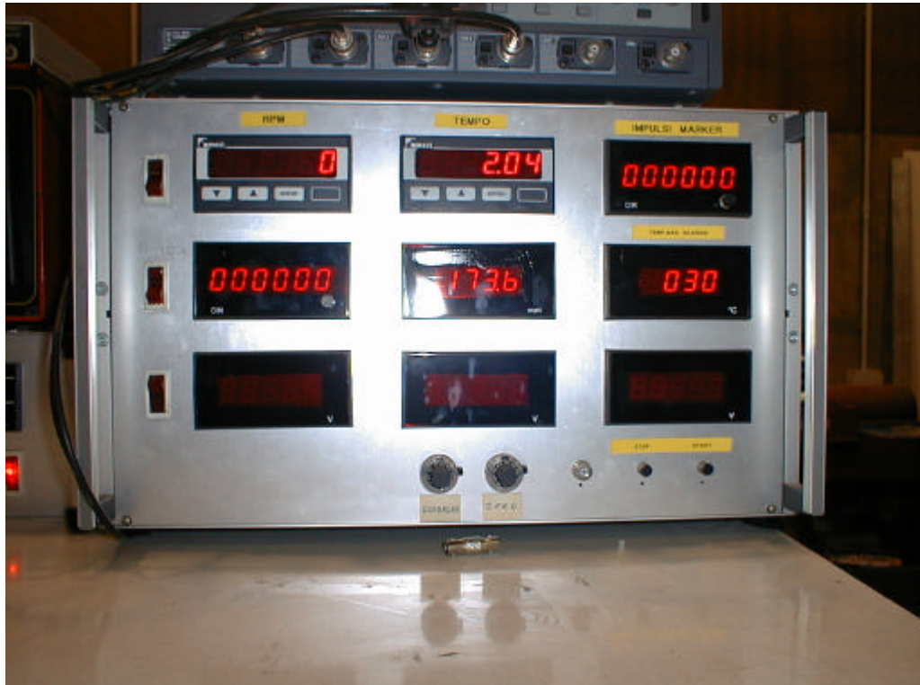
Figura V.15 Dettaglio della centralina su cui è possibile leggere in alto: giri motore, tempo, contaimpuls marker; a metà strumento a destra: temperatura gas di scarico; in basso start e stop del cronometro.
