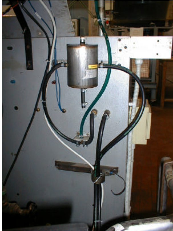
Figura V.10 Degasatore benzina fissato sul retro del pulpito
