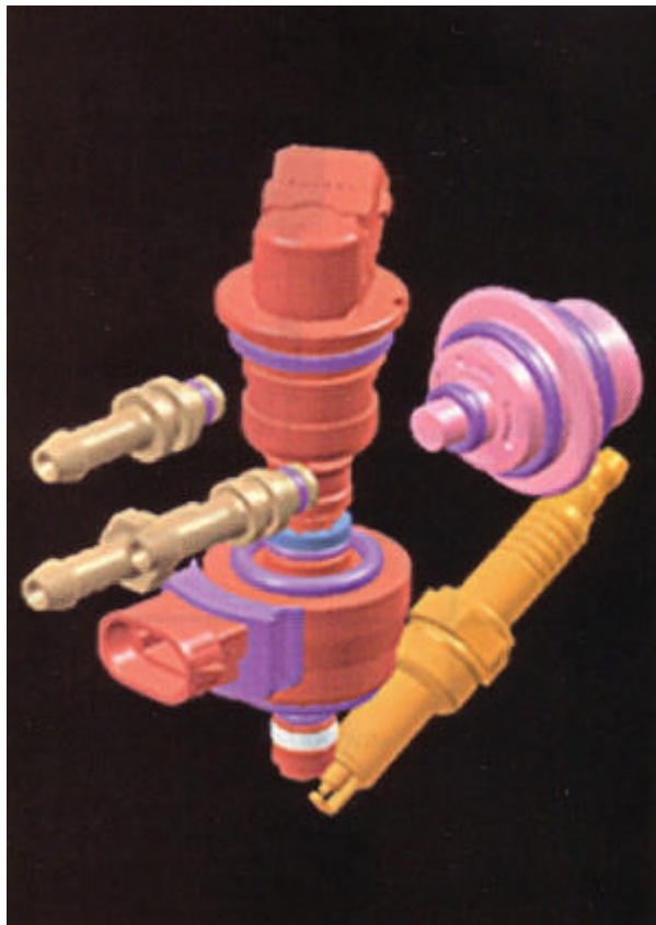
Figura I.14 Dettaglio della candela, del regolatore di pressione, dei raccordi di andata e ritorno benzina e del tandem di iniettori
