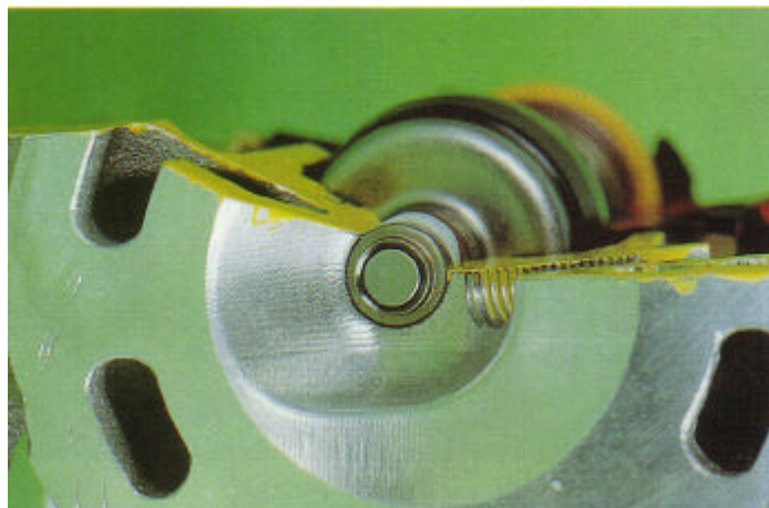
Figure I.7-8-9 Dettagli della camera di combustione del Ditech raffreddato a liquido
