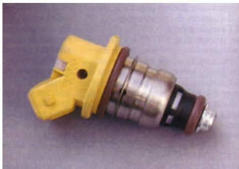
Figura I.53 Iniettore Siemens realizzato su specifiche Bimota
