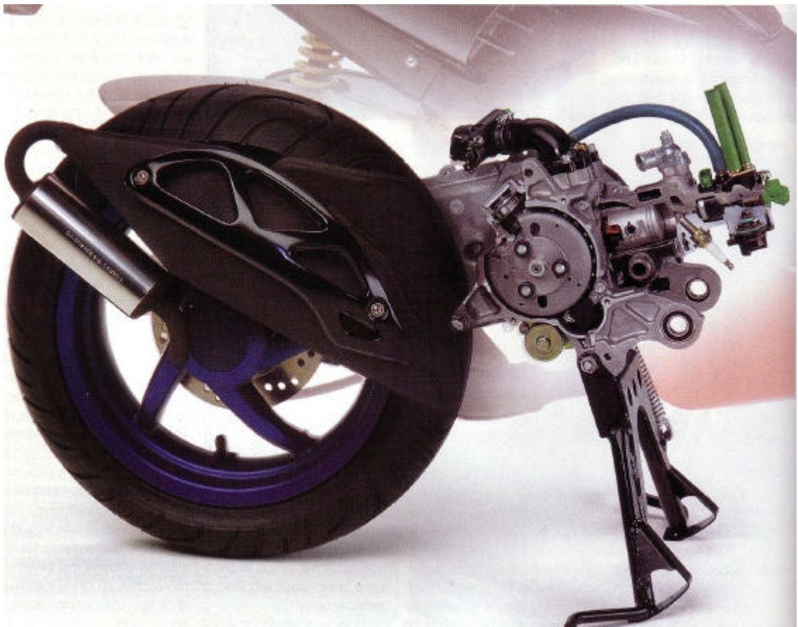
Figura I.1 Motore Ditech Aprilia raffreddato a liquido per scooter SR
