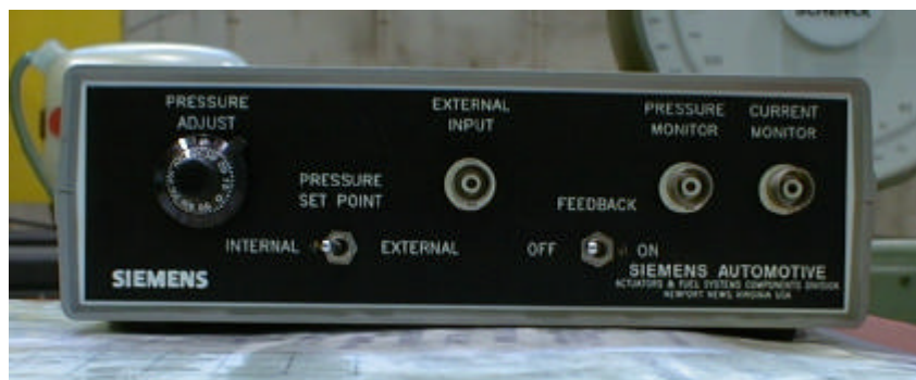
Figura V.16 Dettaglio della centralina di regolazione pressione benzina
