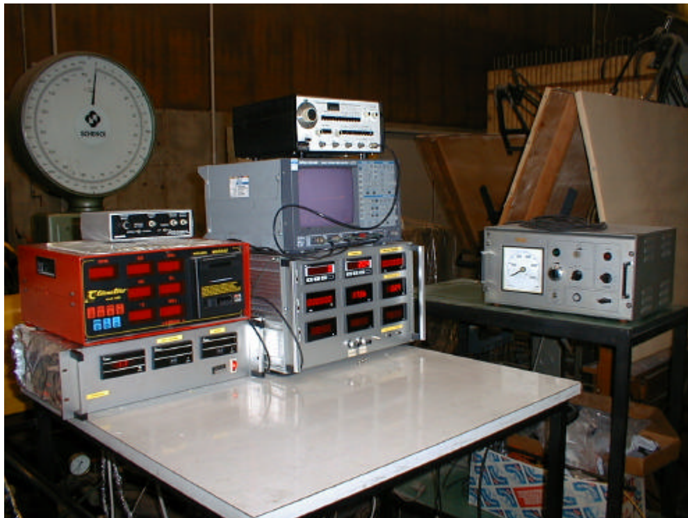
Figura V.14 Centraline di accensione, gestione pressione benzina ed oscilloscopio. Si vedono anche sulla destra la centralina di controllo del freno e sullo sfondo a sinistra la bilancia. Sopra all'oscilloscopio è presente un generatore di onde usato a lungo nelle fasi di messa a punto dell'intero sistema elettronico del prototipo.
