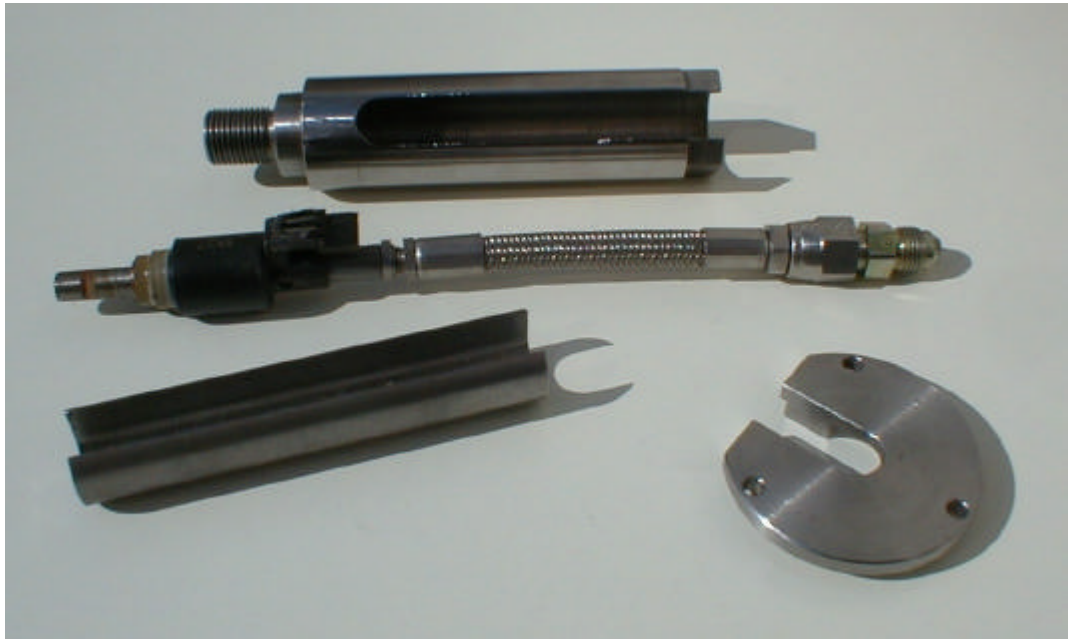
Figura IV.8 Componenti del porta- iniettore
