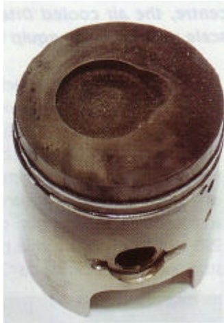
Figura I.5 Pistone del motore Ditech raffreddato ad aria con pozzetto
